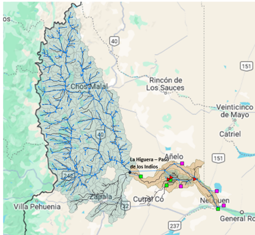
Figura 3. Configuración del modelo de la cuenca del río Neuquén en WaterALLOC. Se muestra en verde la cuenca activa y en marrón la cuenca del modelo de demanda.
