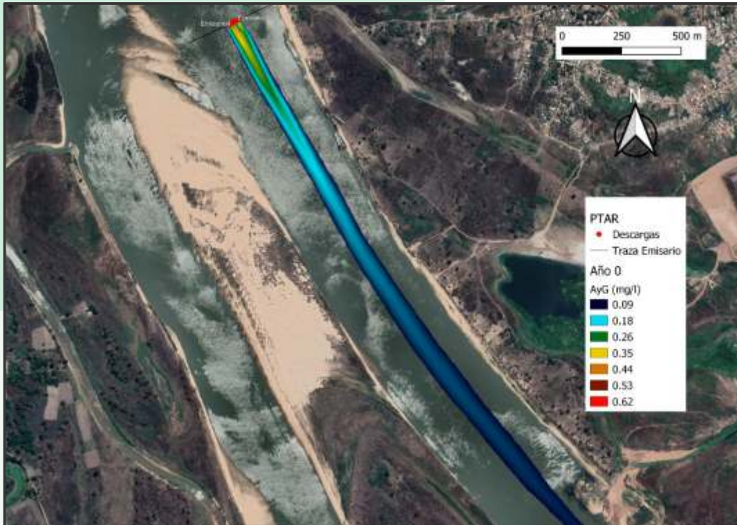
Figura 53. Pluma de contaminación para Grasas y Aceite para el escenario 1, año 0 en la PTAR de Lambaré.
