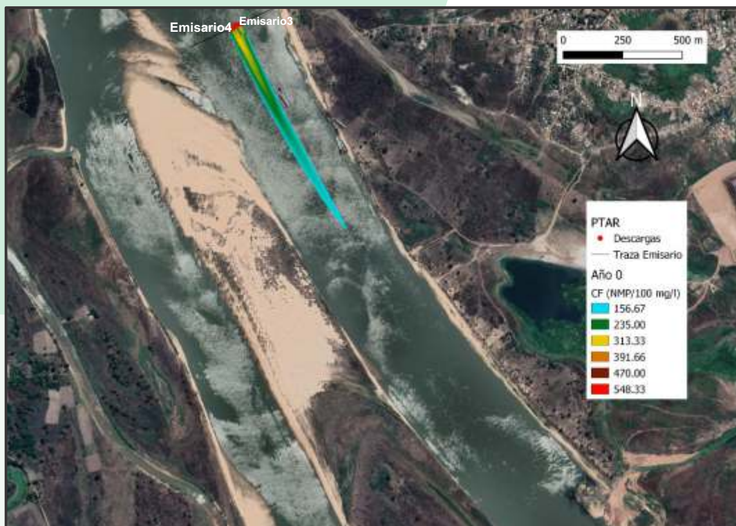
Figura 73. Pluma de contaminación para Coliformes Fecales para escenario 2, AÑO 0 – AA para PTAR Lambaré.
