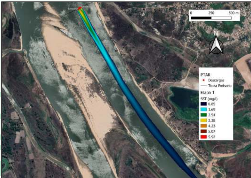
Figura 56. Pluma de contaminación para Sólidos Suspendedos para, escenario 1, ETAPA 1 en la PTAR Lambaré.
