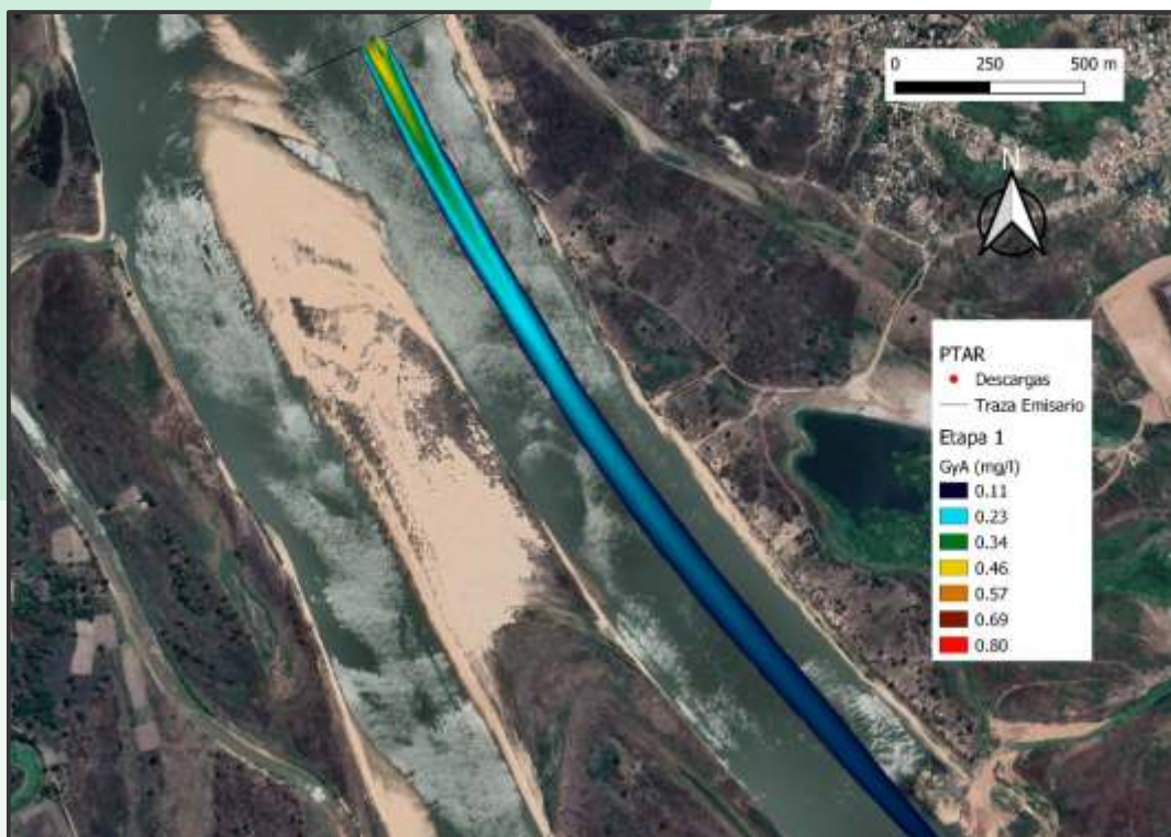
Figura 81. Pluma de contaminación para Grasas y Aceite para escenario 2, ETAPA 1 – AM en PTAR Lambaré.
