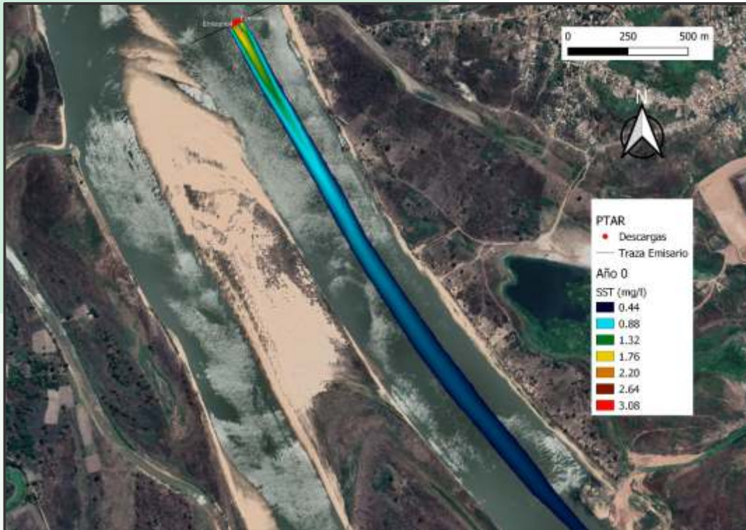
Figura 49. Pluma de contaminación para Sólidos Suspendedos para el escenario 1, año 0 en la PTAR de Lambaré.
