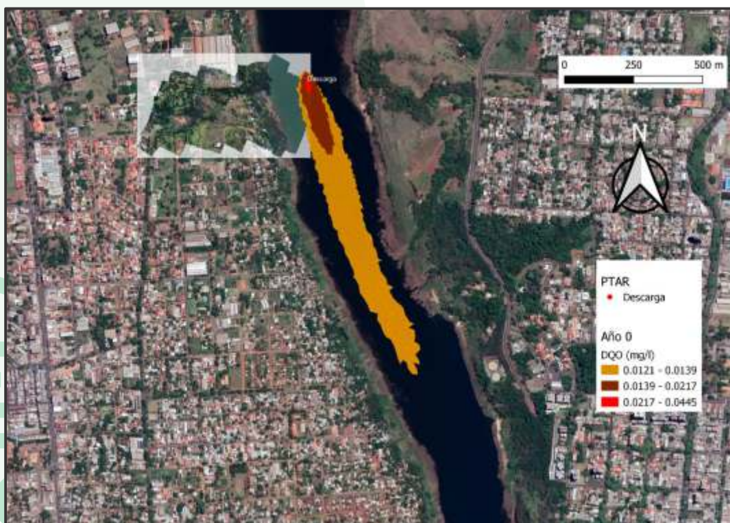
Figura 21. Pluma de contaminación para DQO en PTAR CDE para el escenario 1.
