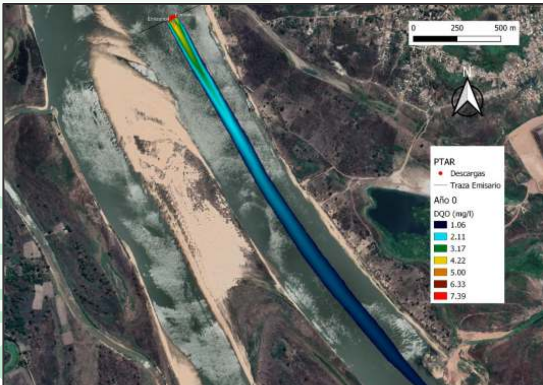
Figura 48. Pluma de contaminación para DQO para el escenario 1, año 0 en la PTAR de Lambaré.
