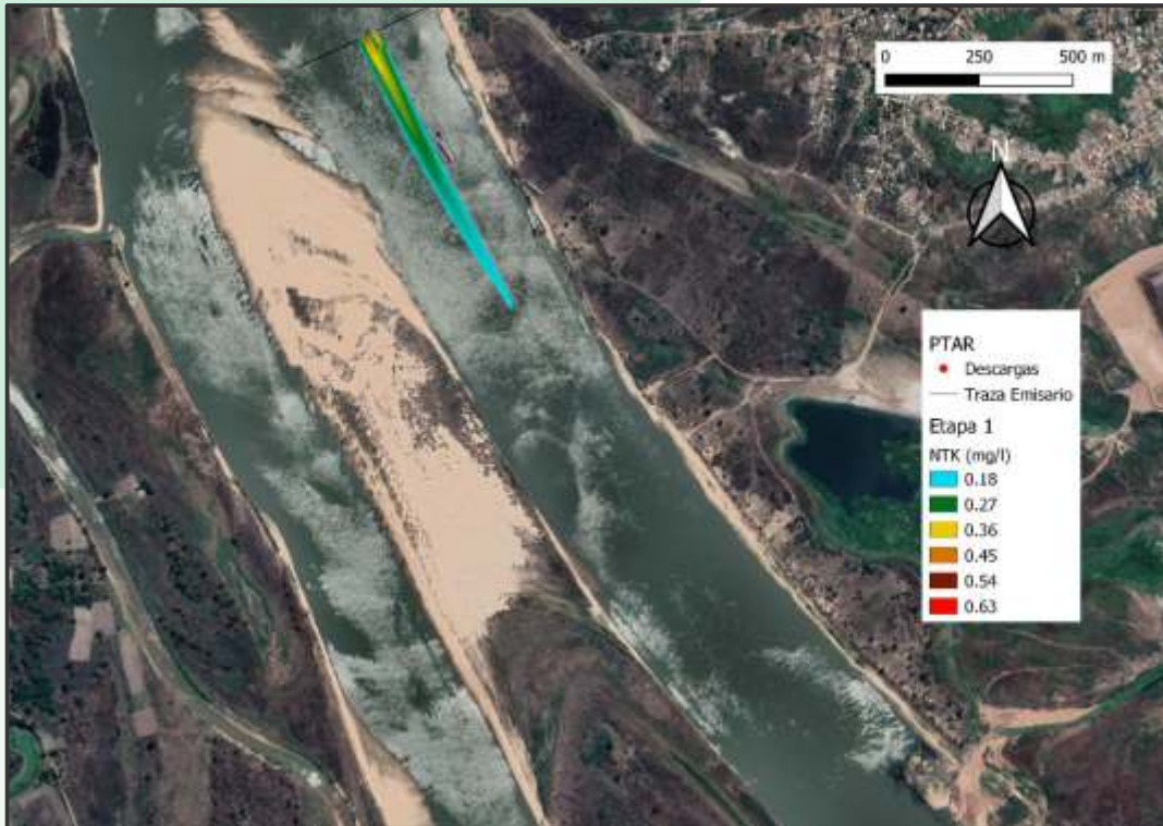
Figura 85. Pluma de contaminación para Nitrógeno para escenario 2, ETAPA 1 – AA para PTAR Lambaré.
