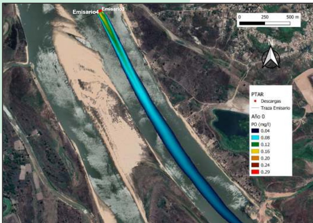
Figura 93. Pluma de contaminación para Fósforo para escenario 3, AÑO 0 para PTAR Lambaré.
