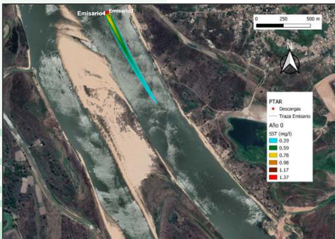
Figura 70. Pluma de contaminación para Sólidos Suspendedos para escenario 2, AÑO 0 – AA para PTAR Lambaré.
