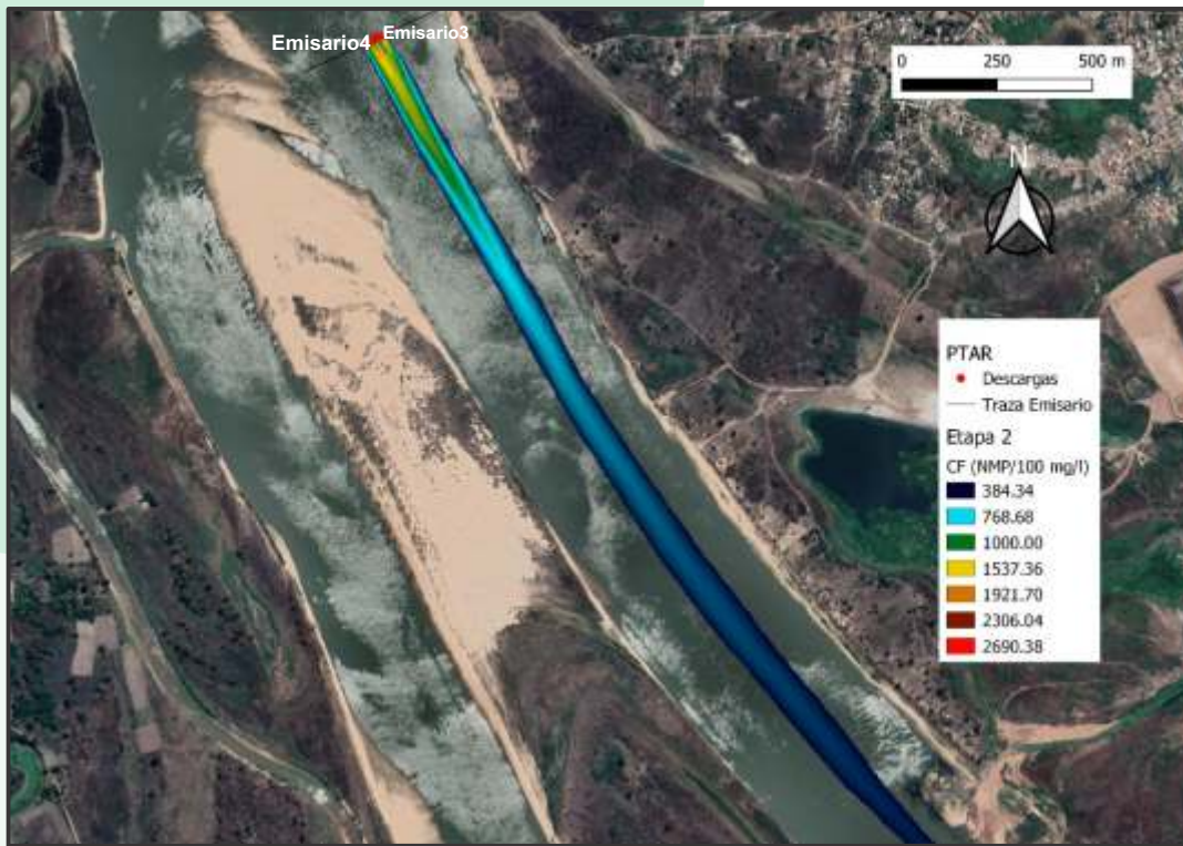
Figura 108. Pluma de contaminación para Coliformes Fecales para el escenario 6, ETAPA 2 (AB) para la PTAR Lambaré.
