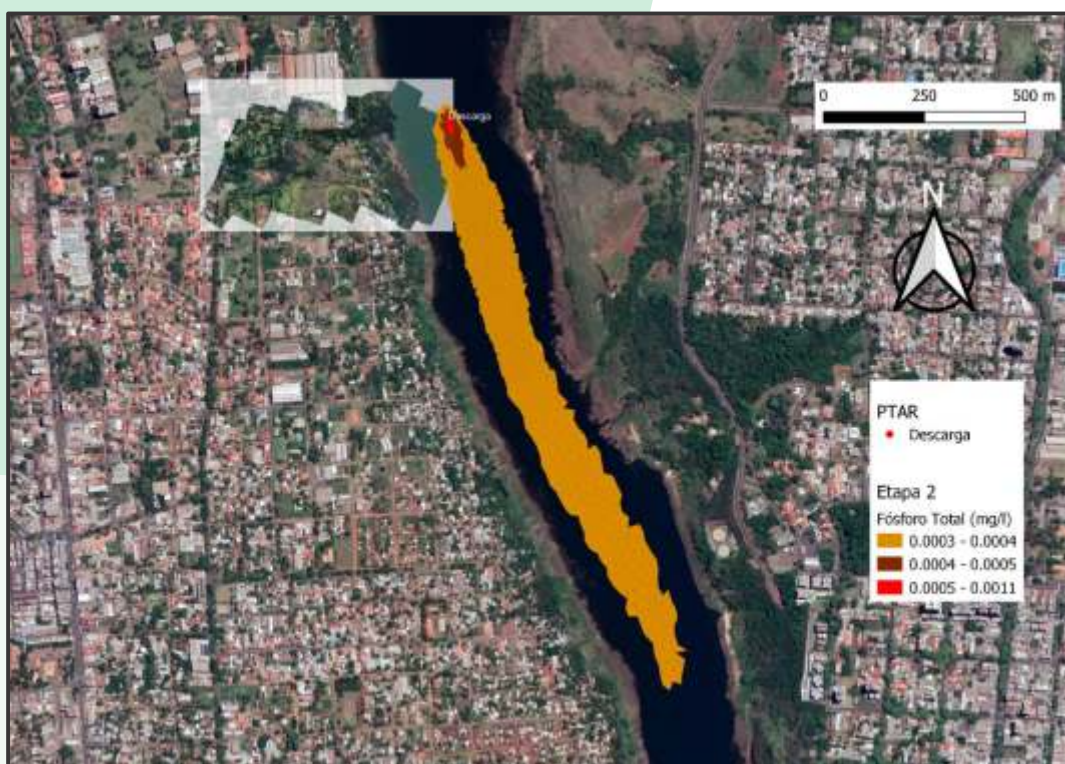
Figura 37. Pluma de contaminación para Fósforo en PTAR CDE para el escenario 3.
