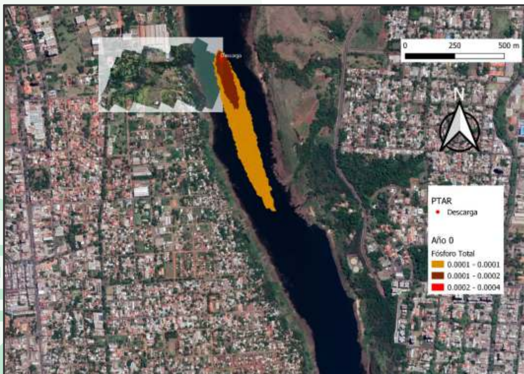
Figura 25. Pluma de contaminación para Fósforo en PTAR CDE para el escenario 1.
