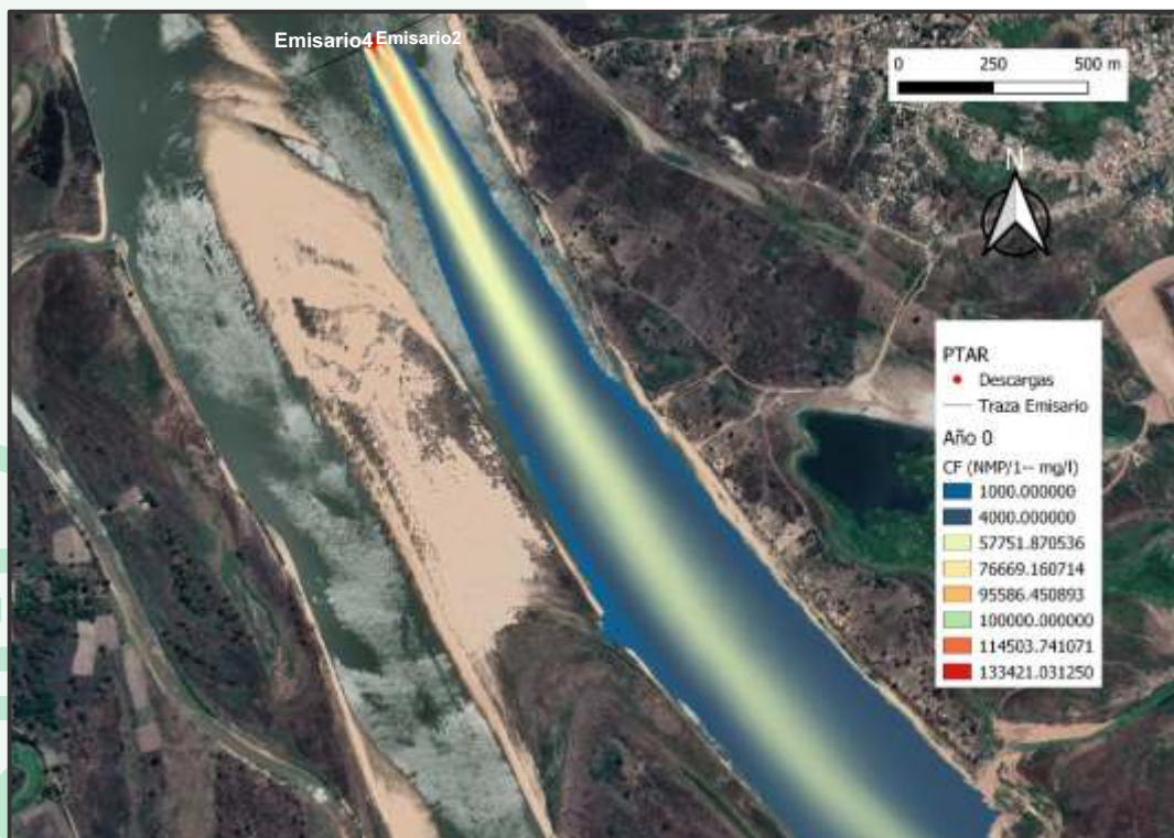
Figura 94. Pluma de contaminación para Coliformes Fecales para escenario 3, AÑO 0 para PTAR Lambaré.
