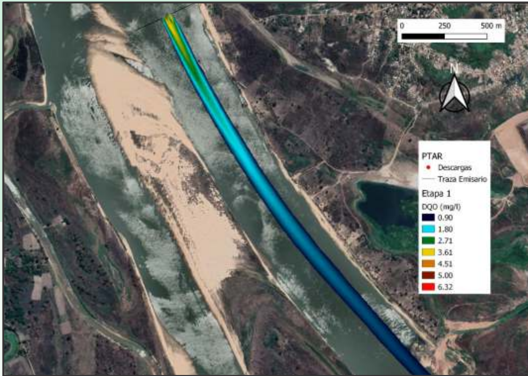
Figura 83. Pluma de contaminación para DQO para escenario 2, ETAPA 1 – AA para PTAR Lambaré.
