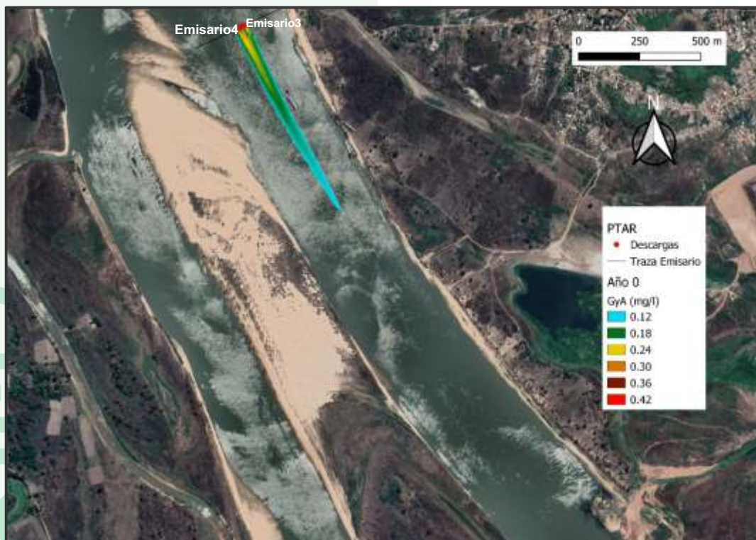
Figura 67. Pluma de contaminación para Grasas y Aceite para escenario 2, AÑO 0 – AM en PTAR Lambaré.
