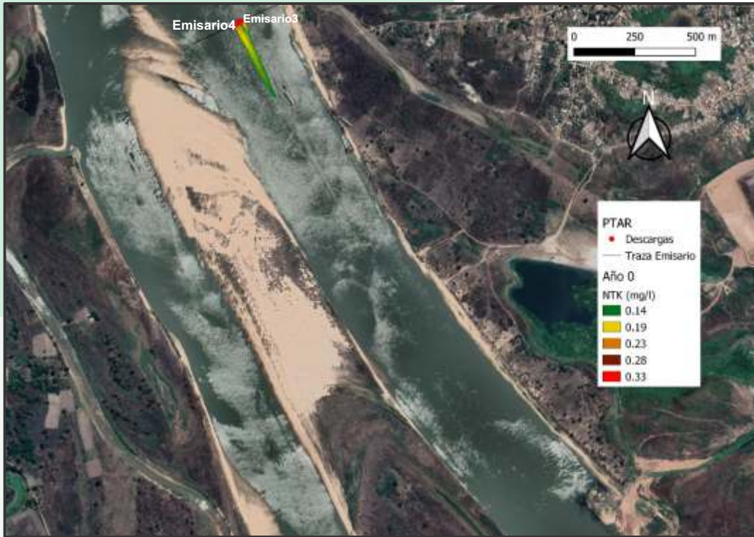
Figura 71. Pluma de contaminación para Nitrógeno para escenario 2, AÑO 0 – AA para PTAR Lambaré.
