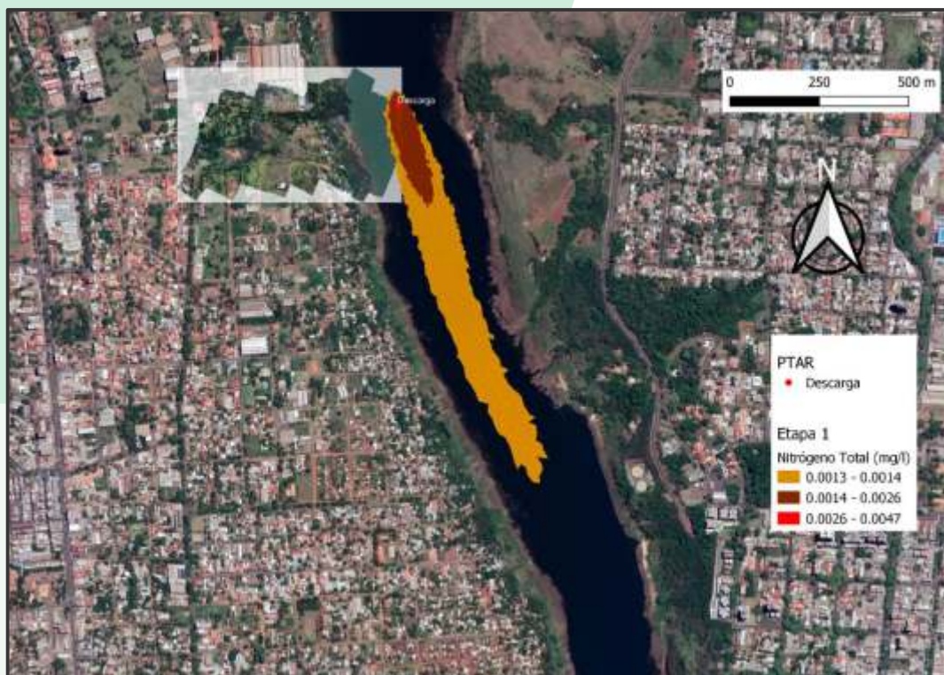
Figura 29. Pluma de contaminación para NTK en PTAR CDE para el escenario 2.
