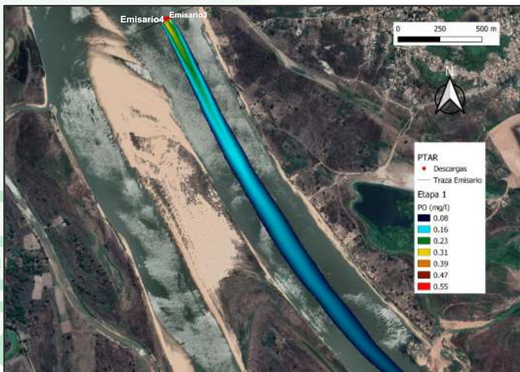
Figura 100. Pluma de contaminación para Fósforo para escenario 3, ETAPA 1 para la PTAR Lambaré.
