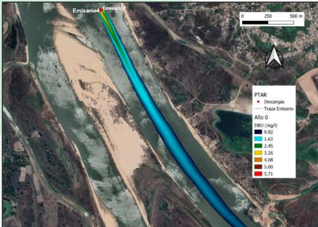
Figura 89. Pluma de contaminación para DBO para escenario 3, AÑO 0 para PTAR Lambaré.
