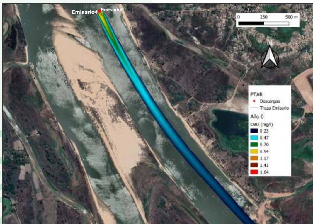
Figura 68. Pluma de contaminación para DBO para escenario 2, AÑO 0 – AA para PTAR Lambaré.
