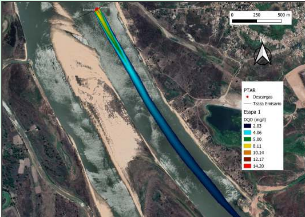
Figura 55. Pluma de contaminación para DQO para, escenario 1, ETAPA 1 en la PTAR Lambaré.
