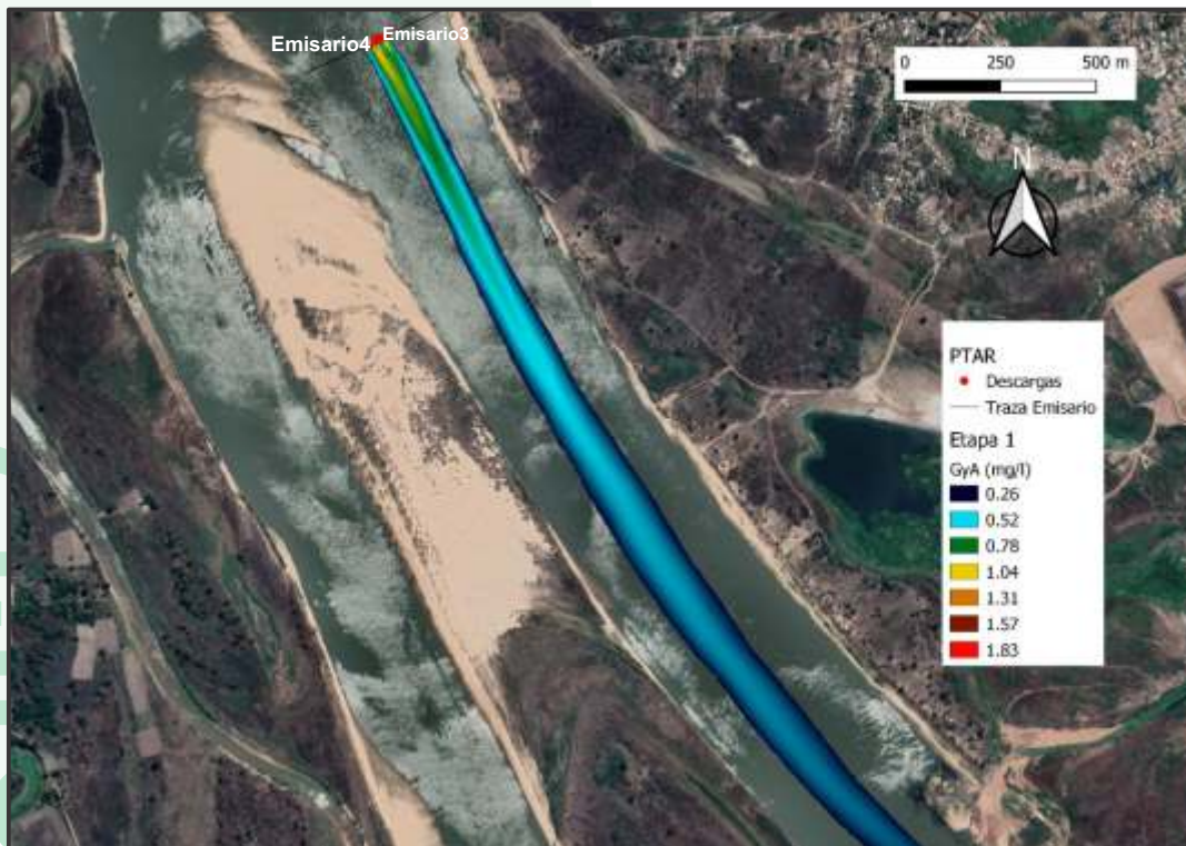
Figura 102. Pluma de contaminación para Grasas y Aceite para escenario 3, ETAPA 1 para la PTAR Lambaré.
