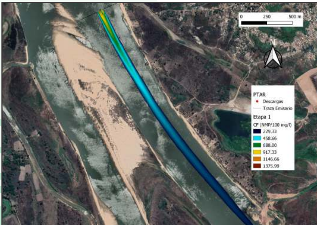
Figura 80. Pluma de contaminación para Coliformes Fecales para escenario 2, ETAPA 1 – AM en PTAR Lambaré.
