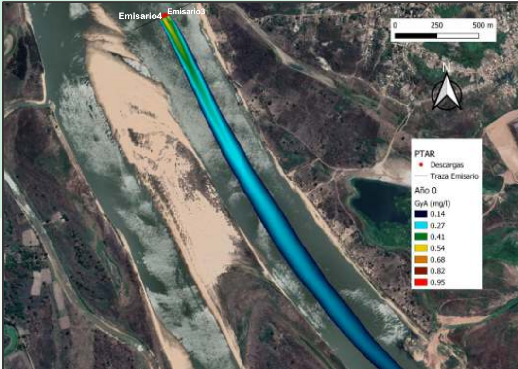
Figura 95. Pluma de contaminación para Grasas y Aceite para escenario 3, AÑO 0 para PTAR Lambaré.
