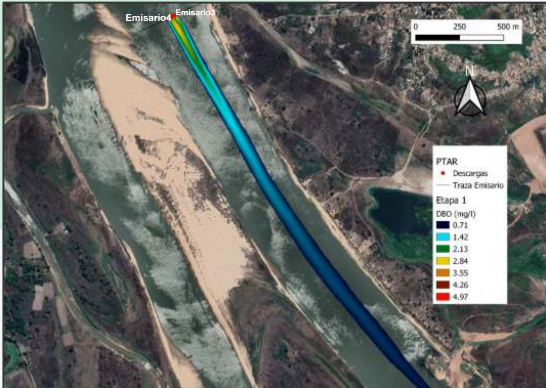
Figura 103. Pluma de contaminación para DBO para el escenario 4, ETAPA 1 para la PTAR Lambaré.
