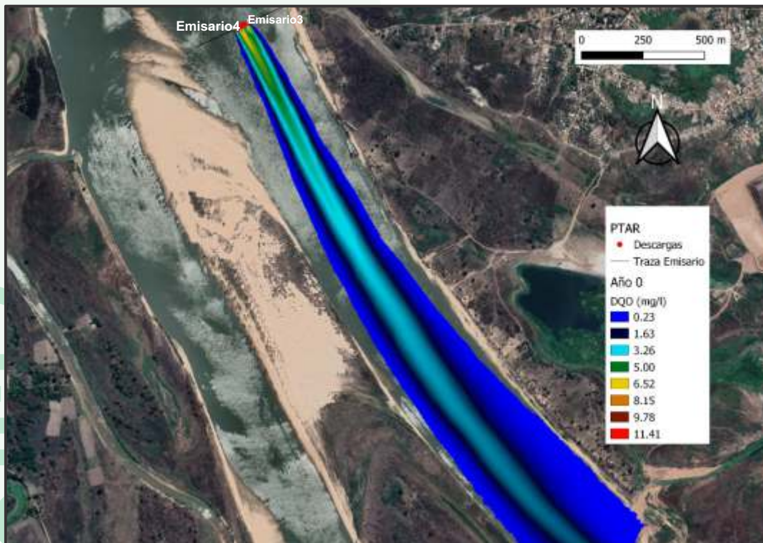
Figura 90. Pluma de contaminación para DQO para escenario 3, AÑO 0 para PTAR Lambaré.
