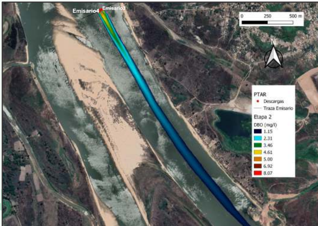
Figura 107. Pluma de contaminación para DBO para el escenario 6, ETAPA 2 (AB) para la PTAR Lambaré.
