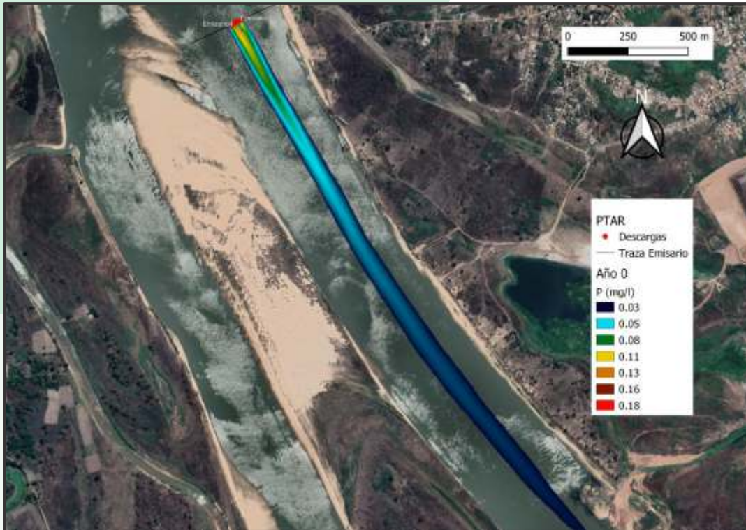
Figura 51. Pluma de contaminación para Fósforo para el escenario 1, año 0 en la PTAR de Lambaré.
