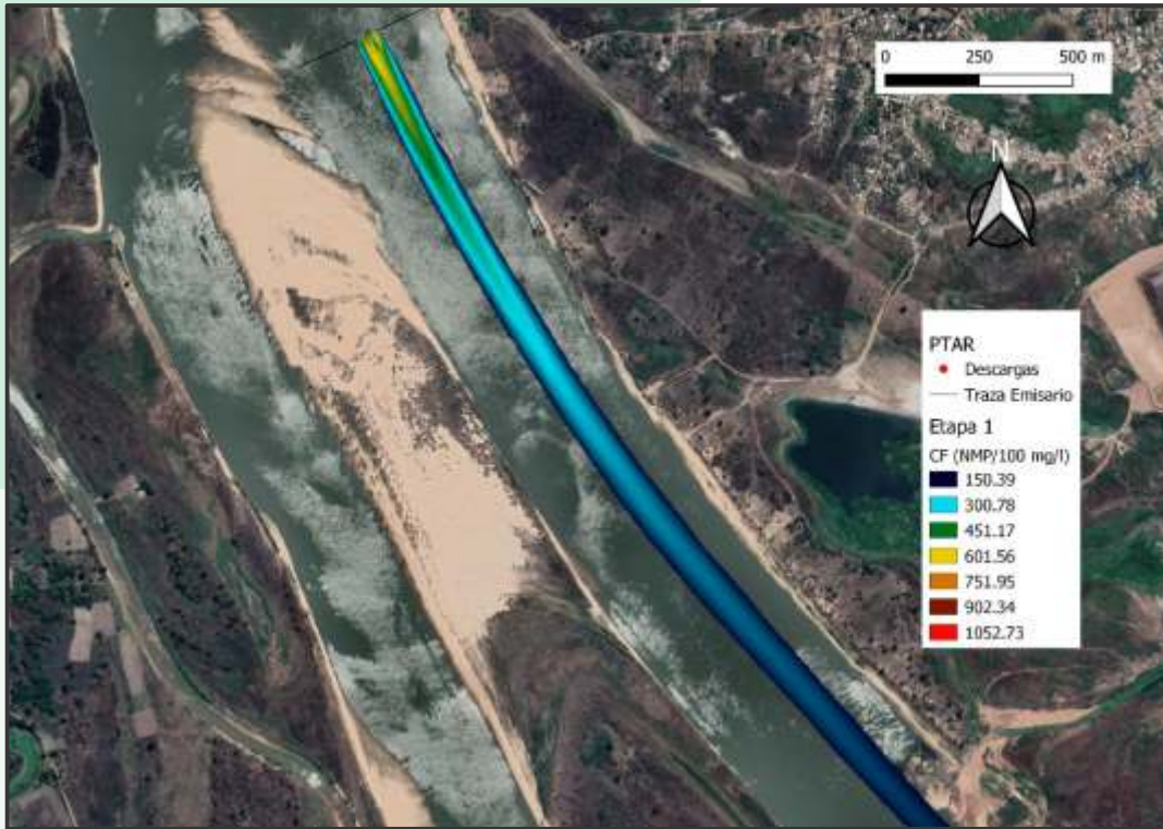
Figura 87. Pluma de contaminación para Coliformes Fecales para escenario 2, ETAPA 1 – AA para PTAR Lambaré.
