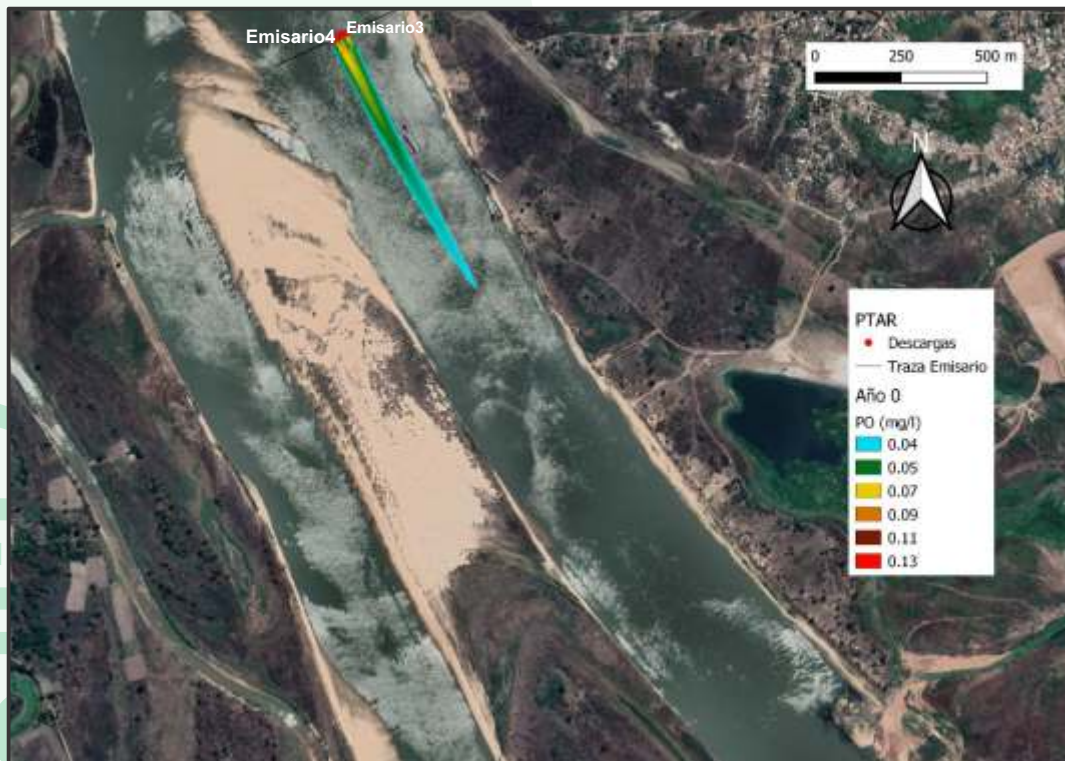
Figura 65. Pluma de contaminación para Fósforo para escenario 2, AÑO 0 – AM en PTAR Lambaré
