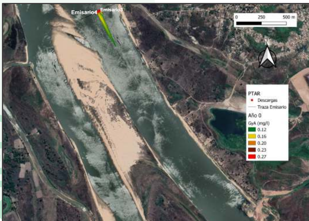
Figura 74. Pluma de contaminación para Grasas y Aceite para escenario 2, AÑO 0 – AA para PTAR Lambaré.
