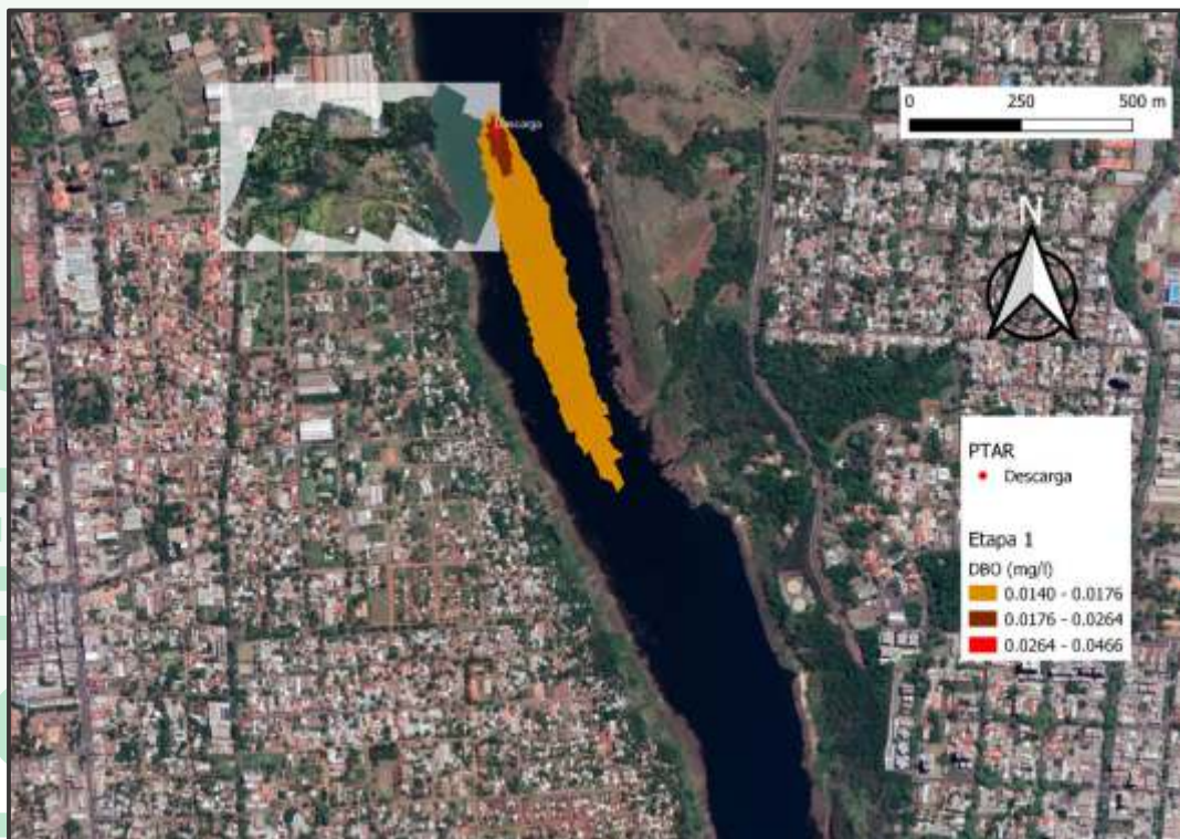
Figura 26. Pluma de contaminación para DBO en PTAR CDE para el escenario 2.
