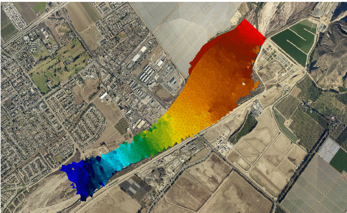
Figura 1.2 – Mapa de elevaciones de la superficie de agua calculadas con HydroBID Flood.
