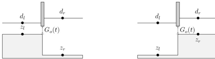
**Figura 7.17** – Niveles de agua para descarga bajo una compuerta sumergida formulados como en (G1).
