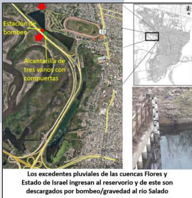
Figura 7. Ubicación del reservorio donde ingresan los excedentes de aguas de lluvia que se generan en las cuencas del Estado de Israel y Flores. Ubicación de la estación de bombeo y alcantarilla que permiten la descarga en el Río Salado.
